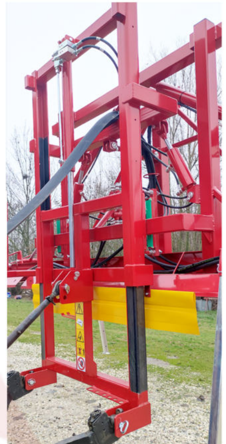
Hydraulische Höhen- Und Neigungsverstellung
