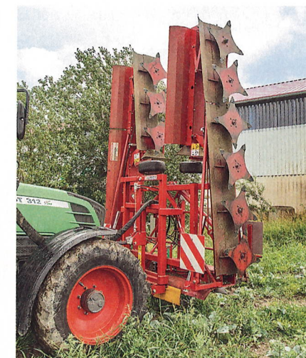
Das Frontgerät lässt sich auf 2,60 m Breite und 3,50 m Höhe klappen. Der Transportschutz ist hier noch nicht angebracht.
