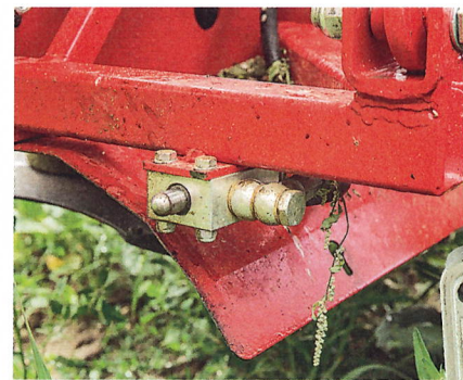
Der mechanische Schalter blockiert bei eingeklapptem Messerbalken den Ölfluss und verhindert so, dass sich die Messer drehen.
