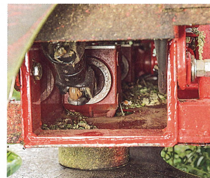
Jeder Messerteller wird beim Unkrautmäher LOP 120S mechanisch über ein Getriebe angetrieben. Fotos: Tovornik
