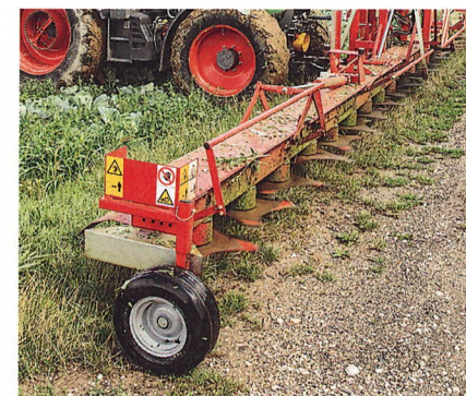
Das seitliche Rad ist kein Stützrad, sondern es schützt lediglich davor, dass die Messer beim Wenden in den Boden stoßen.
