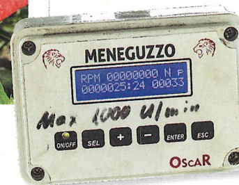
Das Display zeigt die Messerdrehzahl und die Betriebsstunden an.
